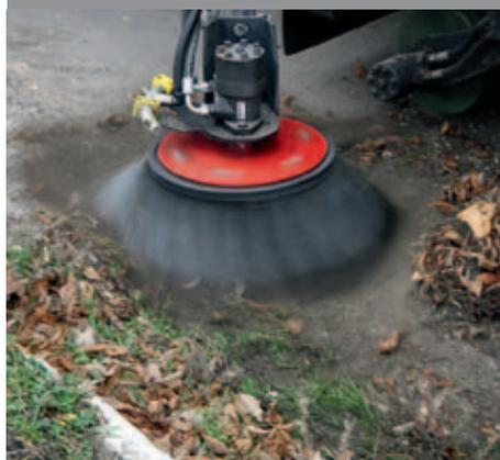
Рабочие органы спецмашины: цилиндрическая поворотная щётка (длина 1500 мм/диаметр 350 мм), дисковая щётка (диаметр 700 мм/вылет 650 мм) и всасывающий раструб (длина 600 мм/диаметр 250 мм).
