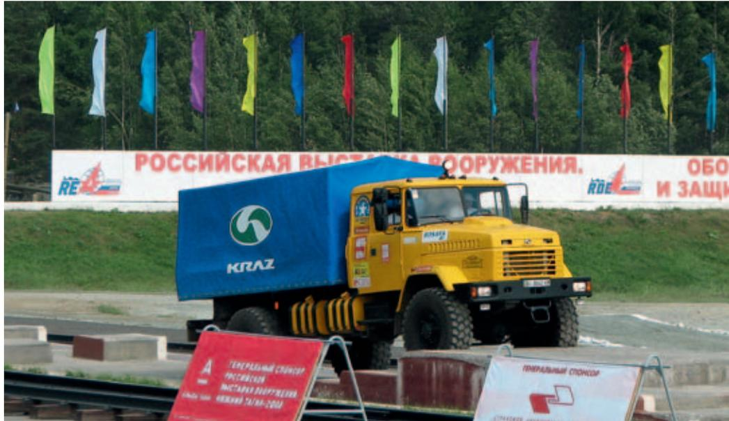
Прохождение автомобиля КраЗ-5233ВЕ по вертикальной стенке. Нижний Тагил, 2007 г.
