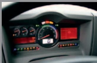
В центре щитка приборов — тахометр со светодиодной шкалой и цифровой спидометр.
