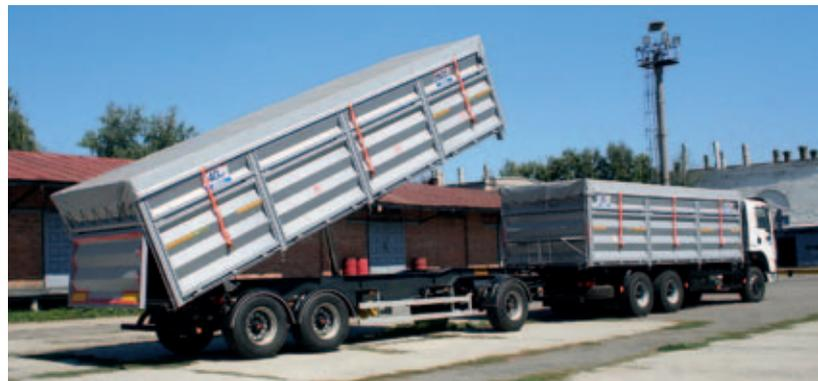
Конструкция прицепа обеспечивает разгрузку не только на правую сторону, но и назад.
