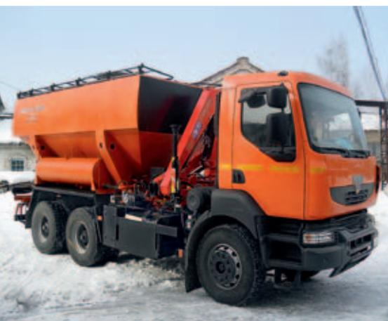
«АвтоКРАЗ» в партнёрстве с машзаводом «Звезда» (г. Карпинск, РФ), на базе бескапотного самосвала КРАЗ С20.Р (6х4) создал новый специальный зарядный автомобиль МЗ-3Б-16. Техническая производительность спецмашины – 600 кг/мин.
