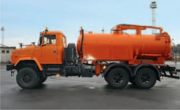
Илососный автомобиль КраЗ-6322 (КО-503ИВ) с оборудованием «Будшляхмаш».
