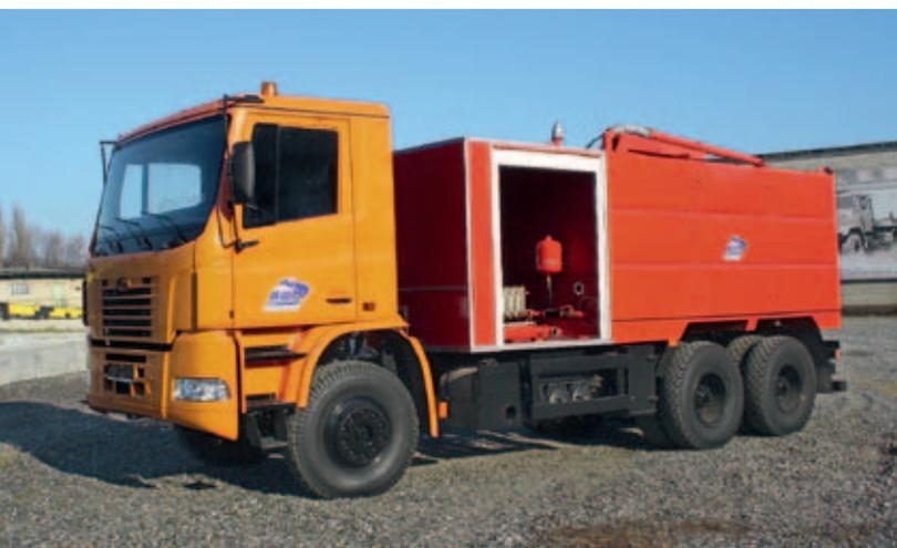
Вакуумный автомобиль КО-503 ИВК на базе шасси КрАЗ Н12.2.
