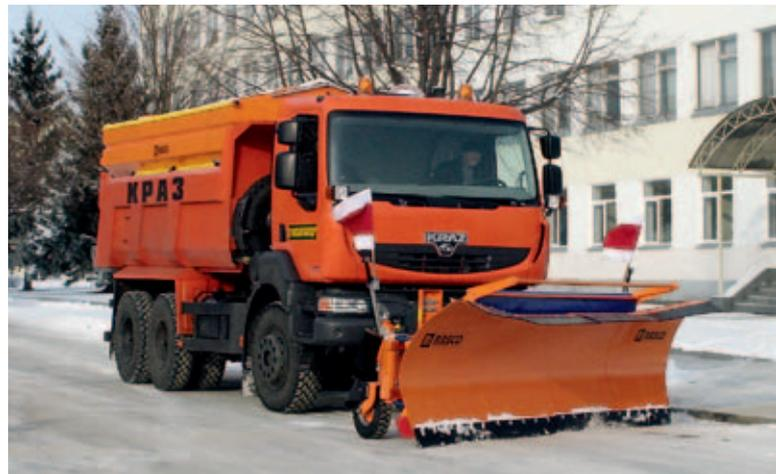
Универсальная КДМ КраЗ С20.2R «Дорожник» со снегоуборочным и антигололёдным оборудованием фирмы RASCO.
