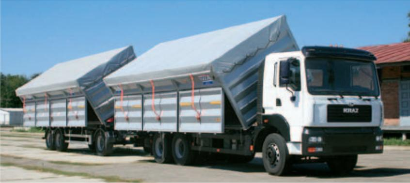
Конструкция платформ обеспечивает самосвальную разгрузку автомобиля на правую сторону.
