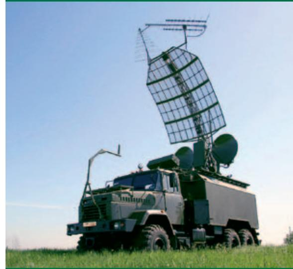
КраЗ-6322РЭБ – база боевого комплекса дальней пассивной радиотехнической разведки «Кольчуга-М».
