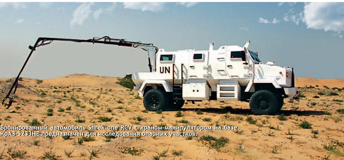
Бронированный автомобиль Shrek one RCV с краном-манипулятором на базе КрАЗ-5233НЕ предназначен для исследования опасных участков.
