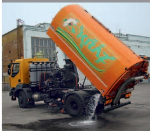
Слив технологической воды после эксплуатации спецмашины.
