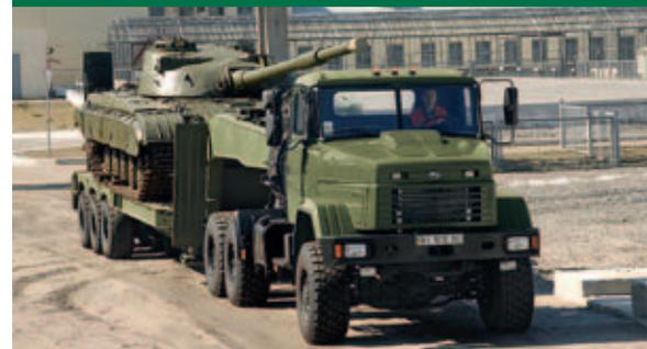
Универсальный седельный тягач-тяжеловоз КраЗ Т17.1ЕХ с полуприцепом.
